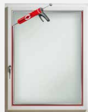
Der verbleibende Spalt zwischen Glas und Rahmen wird umlaufend mit Klebstoff ausgefüllt. Durch die Montage der Glasleiste oder der Abdeckleiste wird die Klebefuge abgedeckt.
